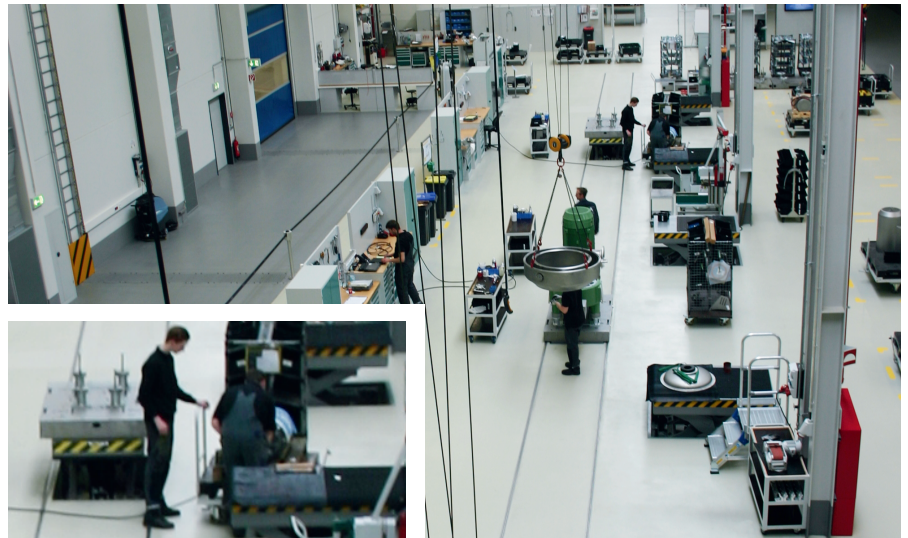
Die neue Fertigungsstraße besteht aus klar definierten Arbeitsstationen und RundSchienen®, die sich praktisch nahtlos in den Hallenboden einfügen. Hubbühnen im Boden bringen die Arbeitsstation inklusive Schienen auf eine ergonomische Höhe.
