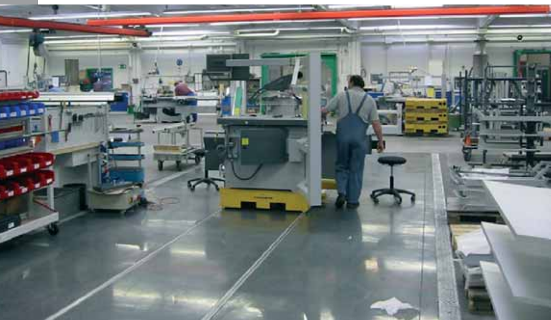
Fließfertigung: Die Maschinen stehen auf Plattformwagen
