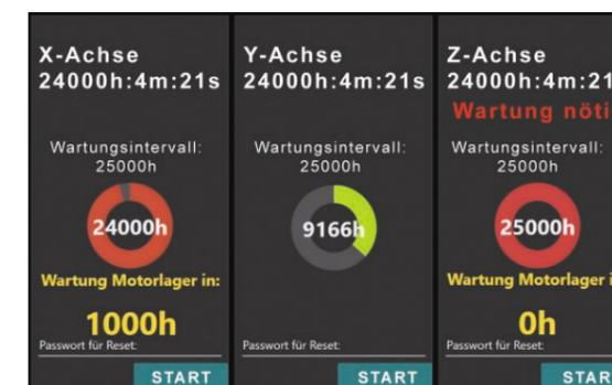
Bei Elektromotoren wird die Einschaltdauer summiert und mit einer rechnerischen Lebensdauer verglichen. Ab einem bestimmten Wert gibt es einen Hinweis, sodass die Wartung in einen produktionsfreien Zeitraum gelegt werden kann.
