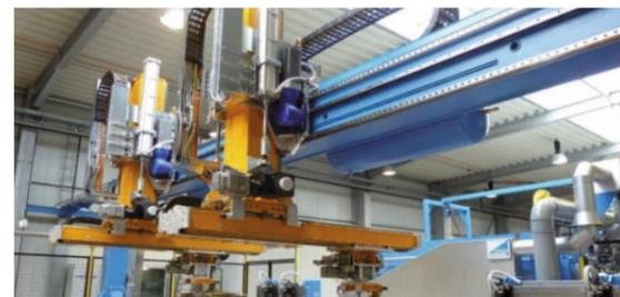
Platinenentstapelung mit Doppelfeedern und 4 Platinenwagen
