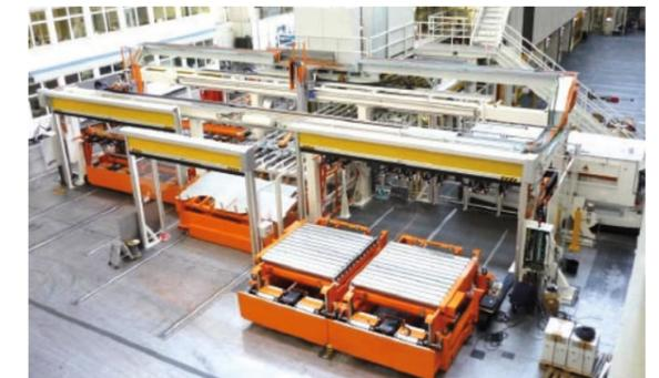
Platinenlader mit automatischer Palettenzentrierung
