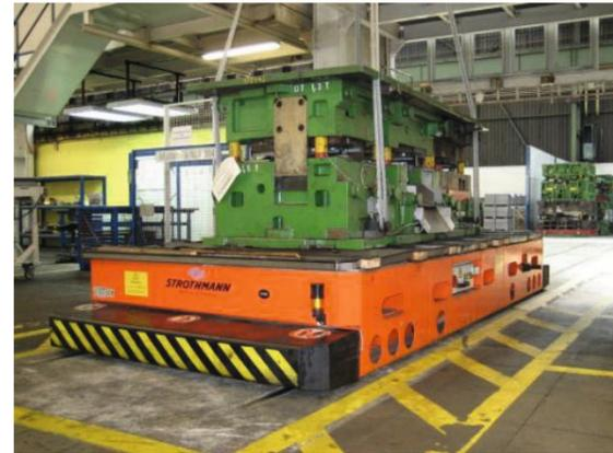
Transportwagen mit integriertem Antrieb für Tiefziehwerkzeuge
