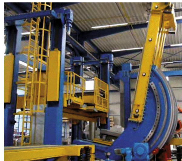
Automatische Stapelanlage für Brennstoffzellen
